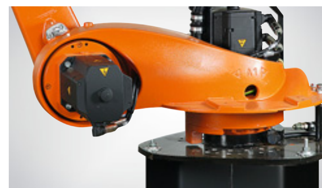
El eje 2 prolongado hacia adelante ofrece una gran flexibilidad y una excelente accesibilidad, en particular al ejecutar trabajos "hacia abajo".
