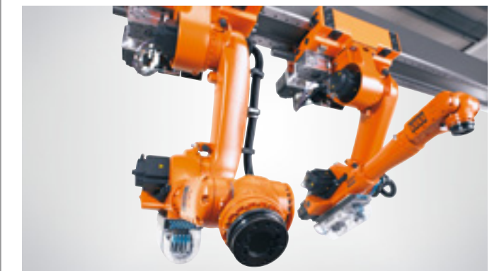
Sobre el eje Jet pueden operar dos robots, lo cual garantiza una flexibilidad máxima.
