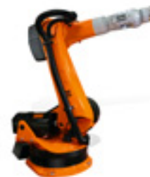
FOUNDRY (F) Robots para áreas con un elevado grado de suciedad y elevadas temperaturas
