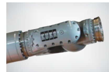
La muñeca del robot, especialmente sellada con una pintura resistente al calor, es capaz de resistir incluso los máximos esfuerzos.
